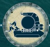
**1984.** Graham Hawkes construye el Deep Rover, un submarino personal con brazos robóticos y cápsula de acrílico capaz de bajar a 900 metros de profundidad.
